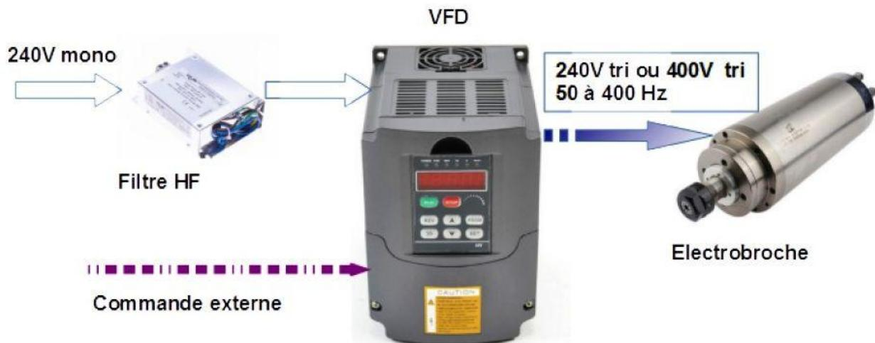
Une électrobroche est composée d'une broche porte-outil accouplée à un moteur triphasé piloté en tension et en fréquence. Pour les fraiseuses à portique amateur on s'appuiera sur des électrobroches d'une puissance de 0,8 kW à 2,2 kW, majoritairement d'origine chinoise. Elles sont alimentées en courant 220V triphasé à une fréquence pouvant monter à 400 Hz. Ce courant est fourni par un VFD (Variable Frequency Driver) en général d'origine chinoise lui aussi.
