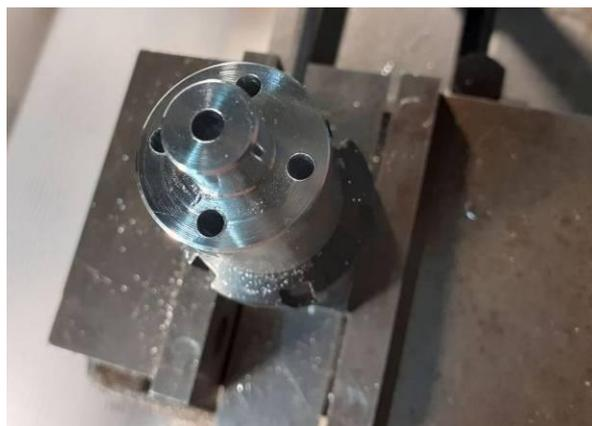
**2.** Reprise en fraiseuse avec un porte-pince carré. Centrage puis décalage en Y de 11mm. Pointage et perçage traversant à  $D = 3,2$  mm. Après perçage le porte-pince est tourné de  $90^\circ$  et repositionné grâce à une butée d'étau.
