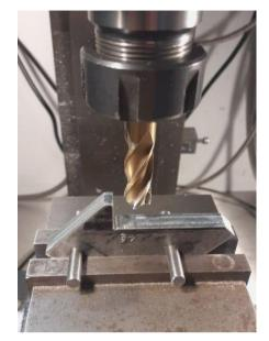
On place deux ronds rectifiés comme montré dans la vue pour fraiser l'hypoténuse (plan incliné de l'équerre) puis ensuite on dégage le redan qui va permette un bon appui de l'ébauche. L'emplacement du redan dépendra de la taille de l'ébauche à usiner.
